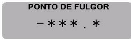
Fica piscante junto com o alerta sonoro quando o ponto de fulgor é encontrado.
