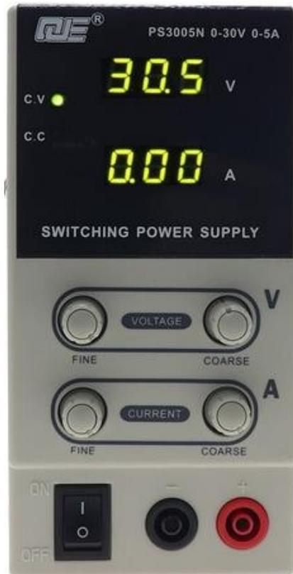
VOLTAGE: Controla o sinal de tensão entre 0 a 30V;
